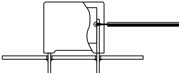
設置溫度，使元件內的最高溫度低於極限：
